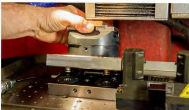
128 mm Bauhöhe maximal: Bauartbedingt lässt die Kern Micro nur 128mm Gesamthöhe zu. Die verbauten Nullpunktspannmodule haben mit 22mm eine extrem flache Einbautiefe. (© AMF)
